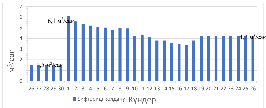
13 - сурет – АБФ ерітіндісін қолдану алдында және одан кейін ұңғыманың 43 –3н – 2 өнімділік динамикасы
